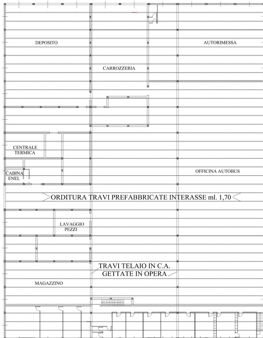
PIANTA PIANO TERRA/PRIMO CON ORDITURA TRAVI DI COPERTURA - Scala 1:200
